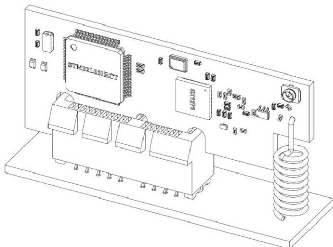
Оснащен торцевым разъемом, для установки в стандартный 36-контактный разъем «PCI-Express», позволяя устанавливать модуль без дополнительной пайки, а также многократно повышая ремонтпригодность всего электронного устройства.
